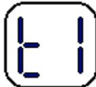
znamená to, že je prúdový transformátor zle pripojený. Buď je zlý fázový uhol medzi napätím a prúdom, alebo má prúdový transformátor prehodené svorky. Akékoľvek zaťaženie odberom by urobilo nastavenie nesprávnym. Ak je prúdové trafo zaťažné odberom a displej neindikuje :
