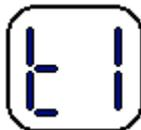
indikuje, že je prúdový transformátor chybné zapojený (nie je správna fáza medzi napätím a prúdom alebo je prúdový okruh prehodený)
